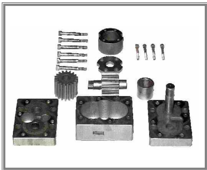
Bild 2 Spinnpumpe (demontiert) nach der Reinigung
