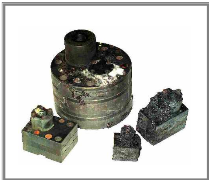
Bild 1 Spinnpumpe (montiert) vor der Reinigung
